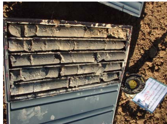
Foto 6 -- Sondaggio S30 – cassetta da 10 a 15 mt
