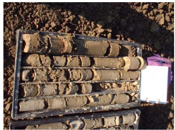
Foto 4 – Sondaggio S30 – cassetta da 0 a 5 mt
