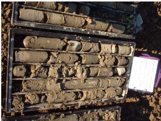
Foto 5 – Sondaggio S1 – Cassetta da 5 a 10 mt
